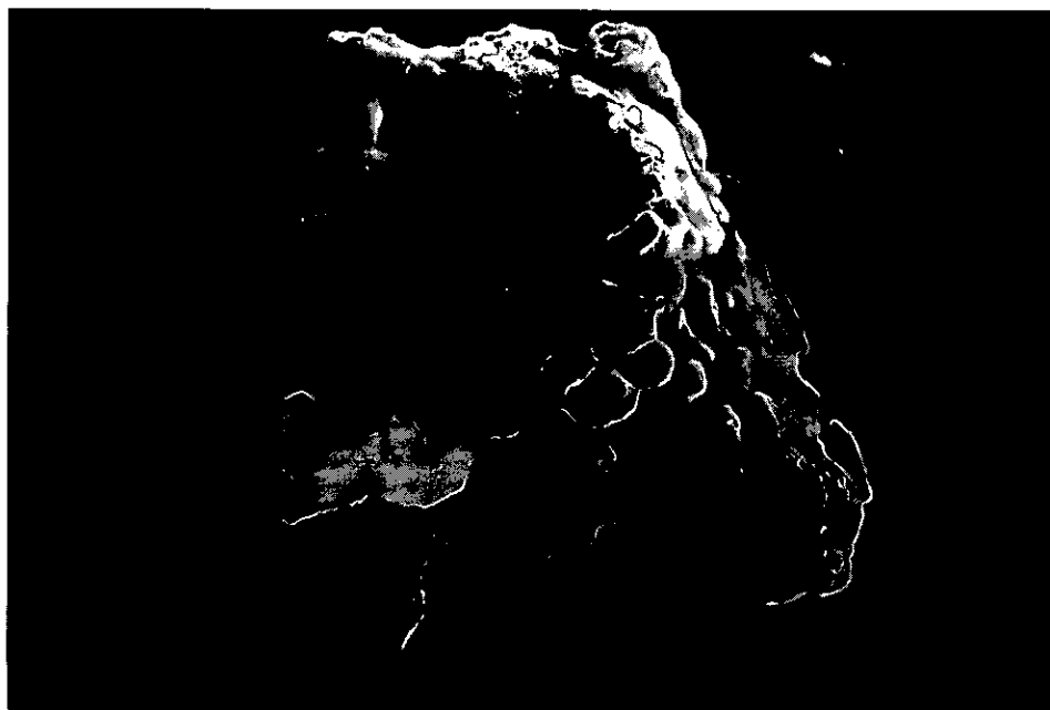
Abb. 13. Goldkorn mit Kristallform (links unten) und schaumig-poröser Struktur aus der myrmekitischen Verwachsung mit Bismut. – REM-Mikrofoto, Bildbreite: ca. 0,3 mm.
