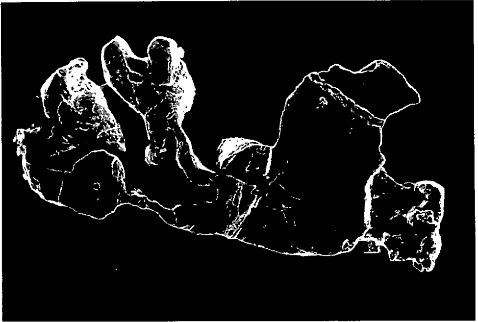
Abb. 14. Löchrig-poröses Goldkorn aus der ursprünglichen myrmekitischen Verwachsung von gediegen Gold und gediegen Bismut. – REM-Mikrofoto, Bildbreite: ca. 0,3 mm
